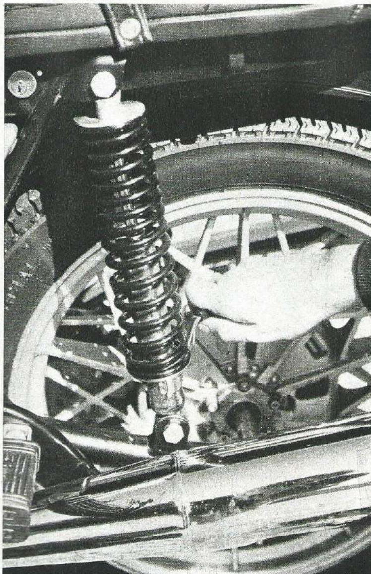
Aquí podemos apreciar uno de los amortiguadores traseros, que admiten la posibilidad de cambiar de posición.
