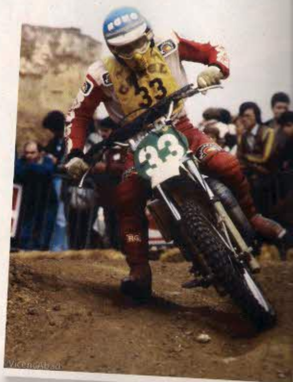
Las principales novedades en la Montesa de cross para 1981 eran visibles a simple vista: suspensión trasera con amortiguadores inclinados y horquilla Marzocchi con barras de 38 mm. Abajo, Albert Ribó, siete temporadas piloto oficial Montesa sobre su Capra VF en 1979. A la derecha, en el buje trasero un Nagesti Assimetric de 150 mm asegura el frenado.
