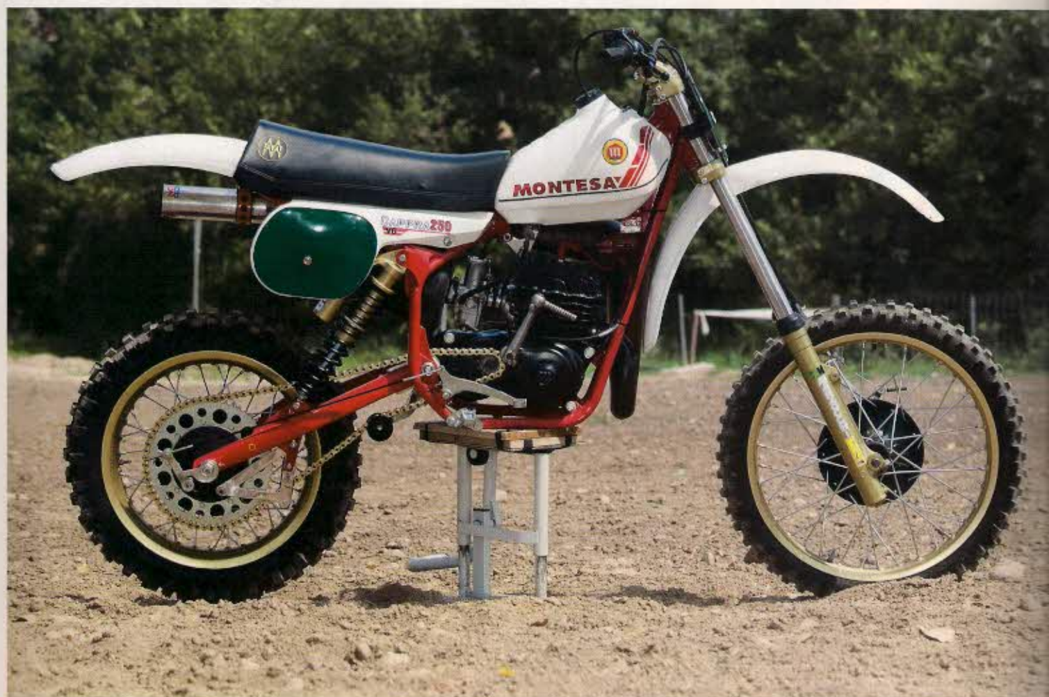
Las principales novedades en la Montesa de cross para 1981 eran visibles a simple vista: suspensión trasera con amortiguadores inclinados y horquilla Marzocchi con barras de 38 mm. Abajo, Albert Ribó, siete temporadas piloto oficial Montesa sobre su Capra VF en 1979. A la derecha, en el buje trasero un Nagesti Assimetric de 150 mm asegura el frenado.
