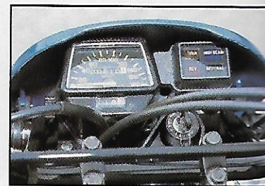
El tablero de instrumentos es muy espartano. El tacómetro ha sido sustituido por un testigo REV de "pase de vueltas".
