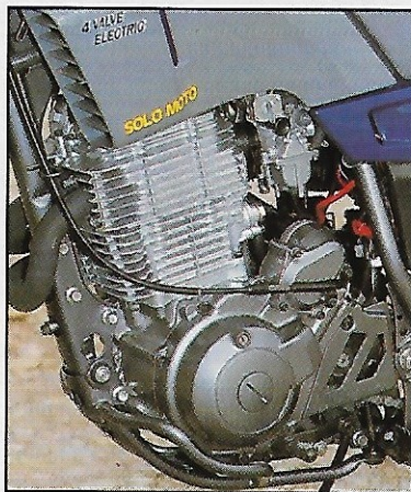
El costado izquierdo del motor muestra el motor de arranque y una tapa del encendido menos voluminosa.
