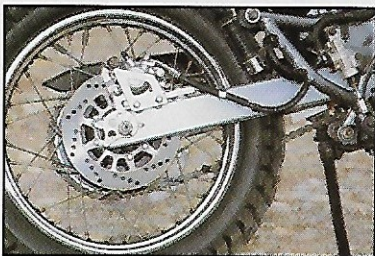
El disco posterior es demasiado potente para conducción por pistas, bloqueando la rueda con suma facilidad.
