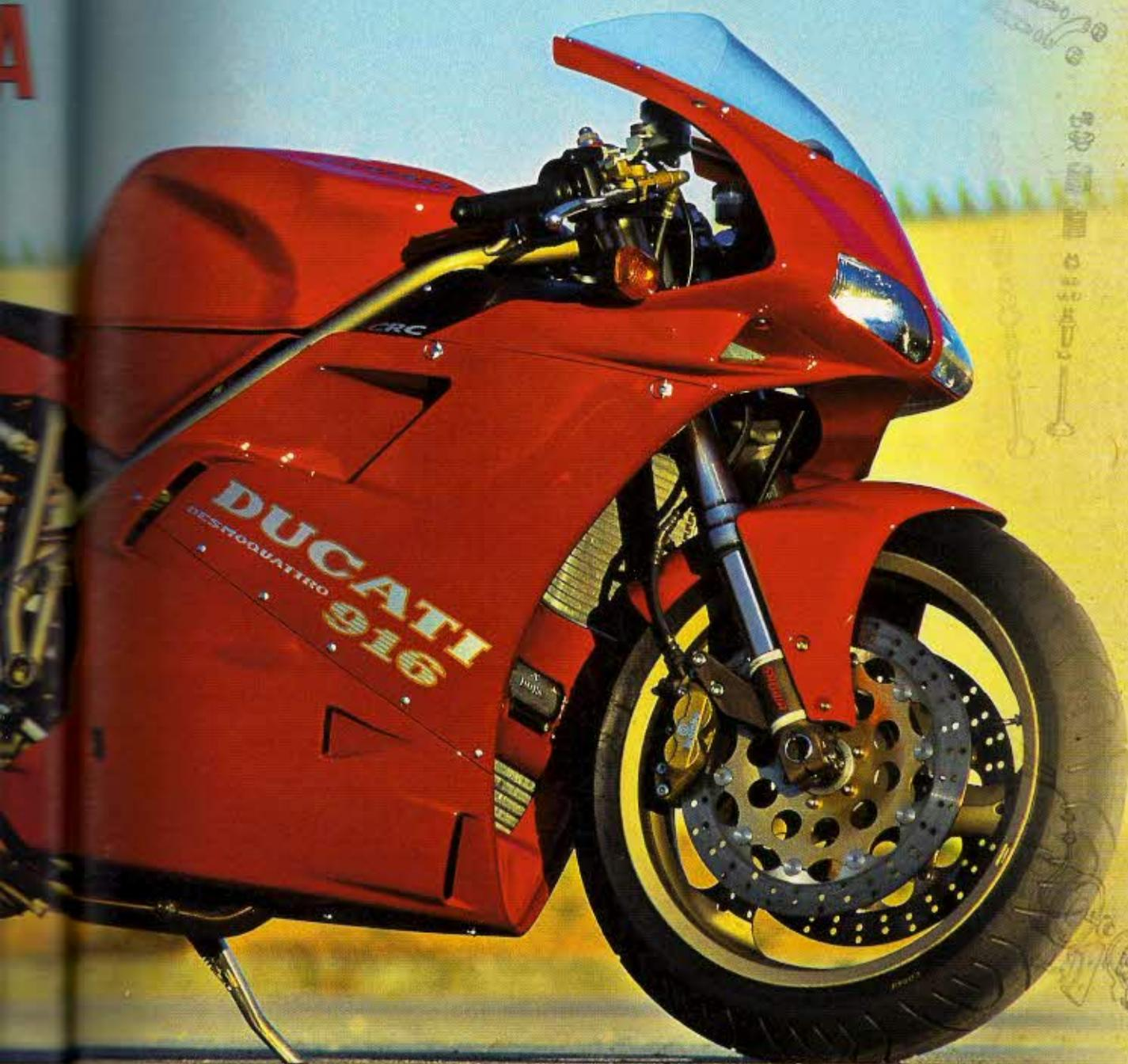
La 916 montaba un motor desmo modificado con 114 CV que le permitía alcanzar una velocidad máxima de unos 250 km/h
