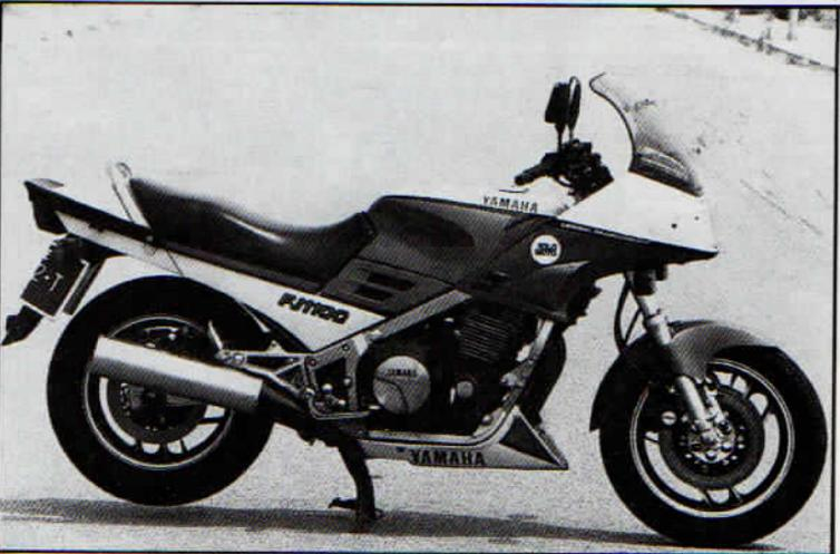
*El motor más potente de todos es el de la Yamaha FJ 1.100 con 125 CV., cuatro cilindros, cuatro válvulas por cilindro, doble árbol de levas en culata, etc.*
