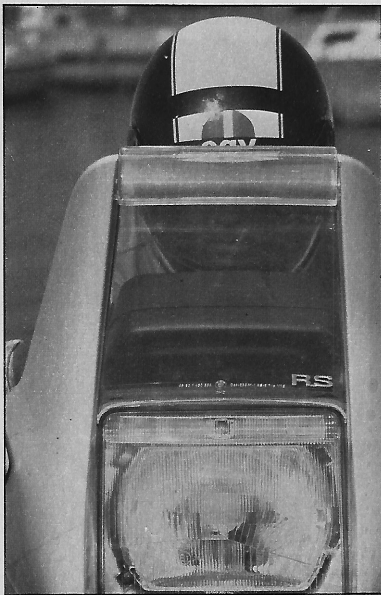
A través de la cúpula del carenado sólo queda una estrecha franja de buena visión entre la parte superior de los relojes y el deflector orientable.
