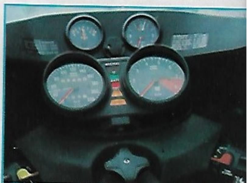
El tablero de instrumentos y sus clavos luminosos que indican, de abajo arriba intermitentes, aceite, punto muerto y carga, y el superior marca el nivel mínimo de líquido de freno.
