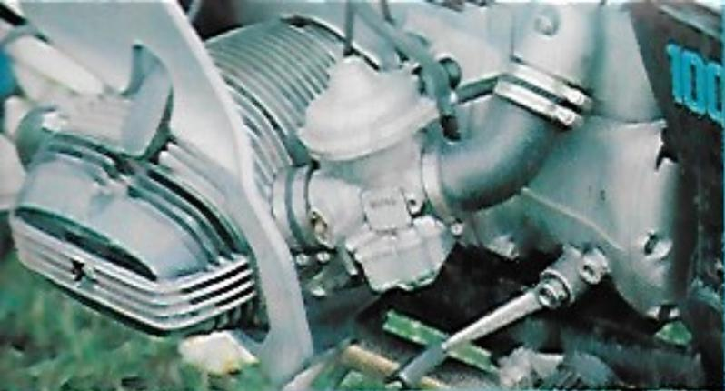
Las principales mejoras del motor quedan prácticamente delimitadas en esta perspectiva. Carburador Bing, de 40 mm. de diámetro; junta tórica en la base del cilindro; empujadores de aluminio y nuevas tapas de balancines. Las pipas de bujía son, asimismo, de nuevo y acetado diseño.
