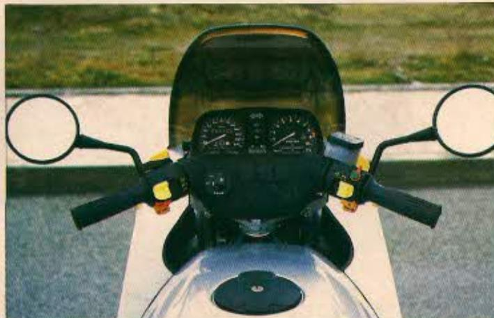
Todo negro en la S «Special» y un detalle más importante, freno, de disco trasero, una ventaja sobre el tambor de la básica o la «C». Las manos no resultan protegidas pero la alta cúpula del carenado de la Special (idéntica a la de la versión S) garantiza que viajarás con poco frío y viento sin necesidad de forzar tu postura.
