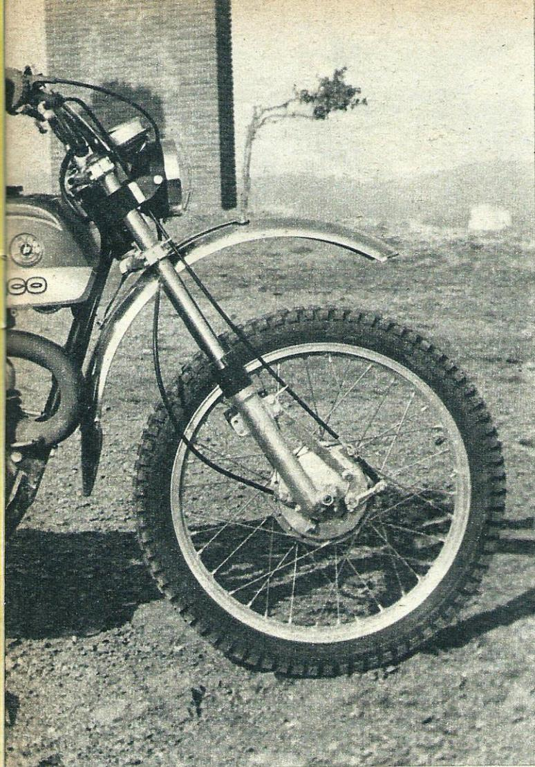
A pesar de la distancia existente entre la rueda y el guardabarros delantero, el neumático llega a tocar con éste en apuradas de frenada en asfalto.
