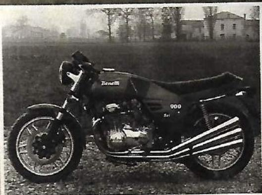
Detalle de la evolución de la 900. En la fotografía podemos ver un primer prototipo preserie que montaba los seis escapes como en la 750. Posteriores pruebas en carretera aconsejaron sustituirlos por el «seis en dos» actual.
