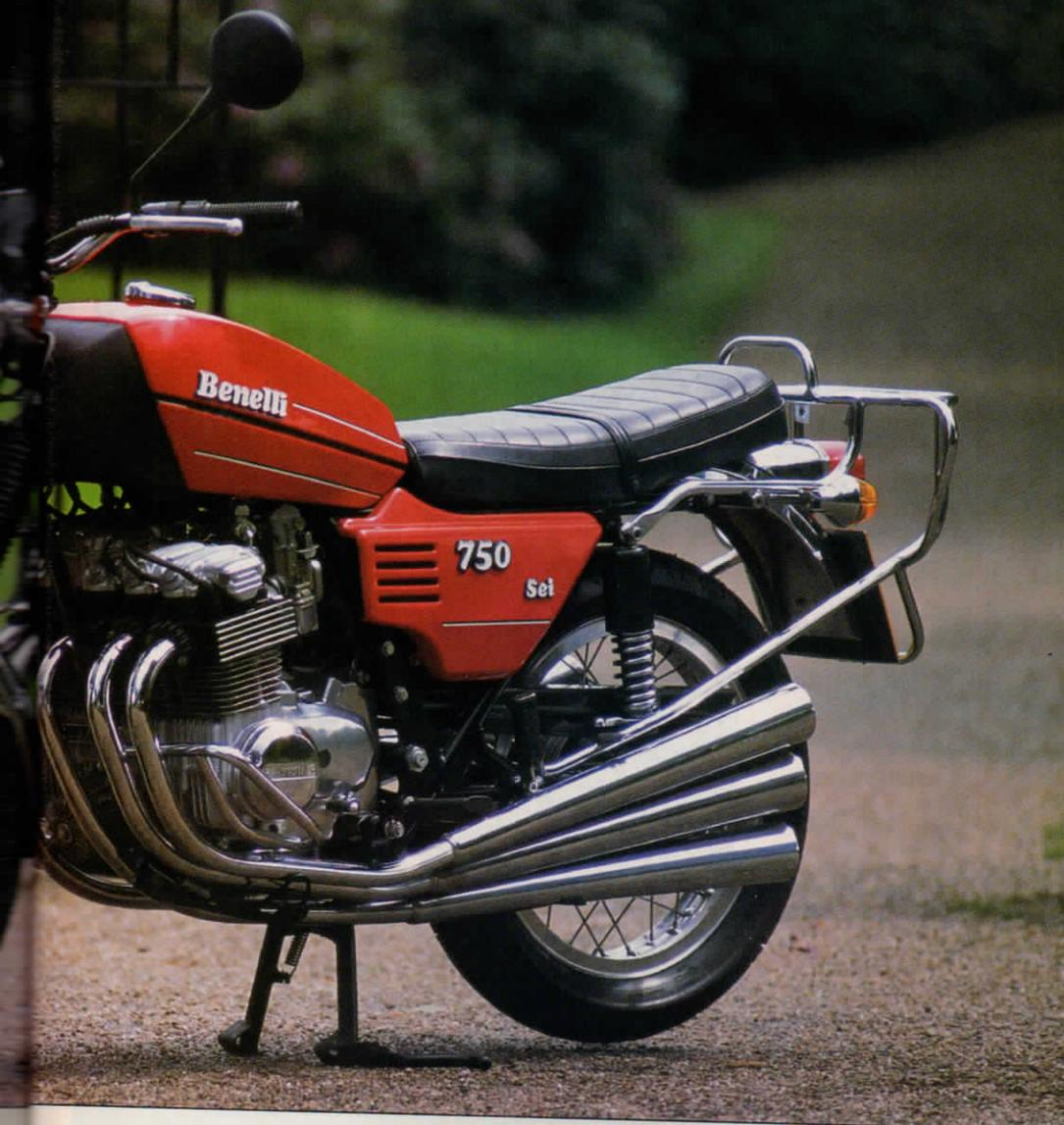
sación de estrechez, se usaban solamente tres carburadores, cada uno de ellos alimentando dos cilindros; los dos exteriores montados en un colector girado hacia el interior, de manera que todos cabían perfectamente debajo del comienzo del redondeado depósito.
