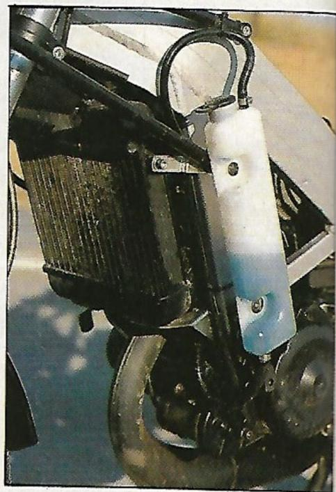
Entre los instrumentos falta una avisador de reserva de gasolina. Nótese la posición del tapón de llenado de aceite y el oculto termómetro de agua. La Jarmo es una moto bastante corpulenta y alta de asiento. En el despiece parcial se puede apreciar el radiador de aluminio, vaso de expansión y soporte del amortiguador.
