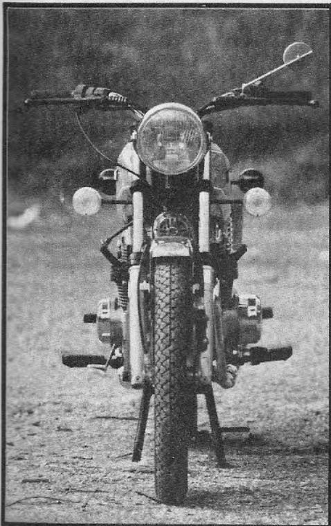
Las dimensiones de esta máquina son especialmente reducidas. Estéticamente se encuentra a faltar un equipo de relojes encima del faro. Este ofrece una buena luminosidad gracias a una lámpara de 40/45 W.
