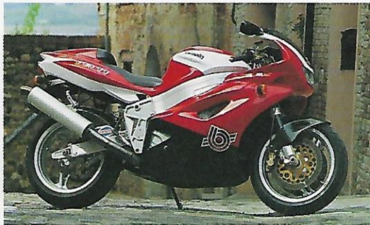
*Izquierda: Diseño estilizado, un bastidor con mástiles amplios y un silenciador cuatro en uno.*
