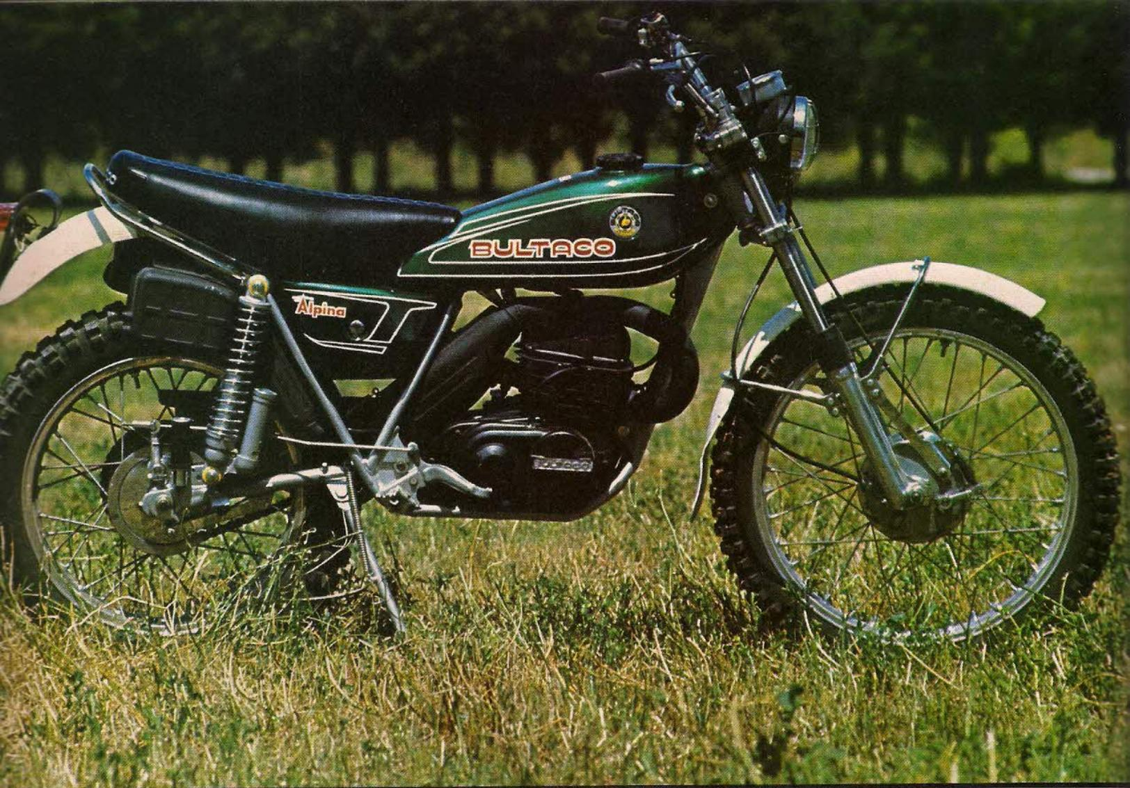
munes a los trial y únicamente en la carrocería —la fibra— se ha cambiado algo el diseño, que siendo muy parecido al de la Sherpa, es en esta máquina más grande de cabida y pintado en un verde metálico con adornos en blanco. Del mismo color son los guardabarros que ahora equipa la máquina en fibra plástica irrompible y que han sustituido a los de la anterior versión que eran metálicos, con la consiguiente mejora en peso y duración.
