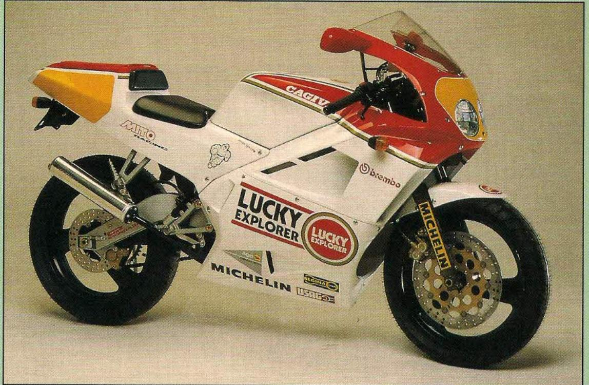
nes técnicas -válvula de potencia electrónica, refrigeración líquida, láminas, mezcla separada, eje de balance antivibraciones, etc., etc.-, se le ha unido una parte ciclo fenomenal. Chasis en tubo de aluminio rectangular en forma de "U" invertida, basculante de bra-
