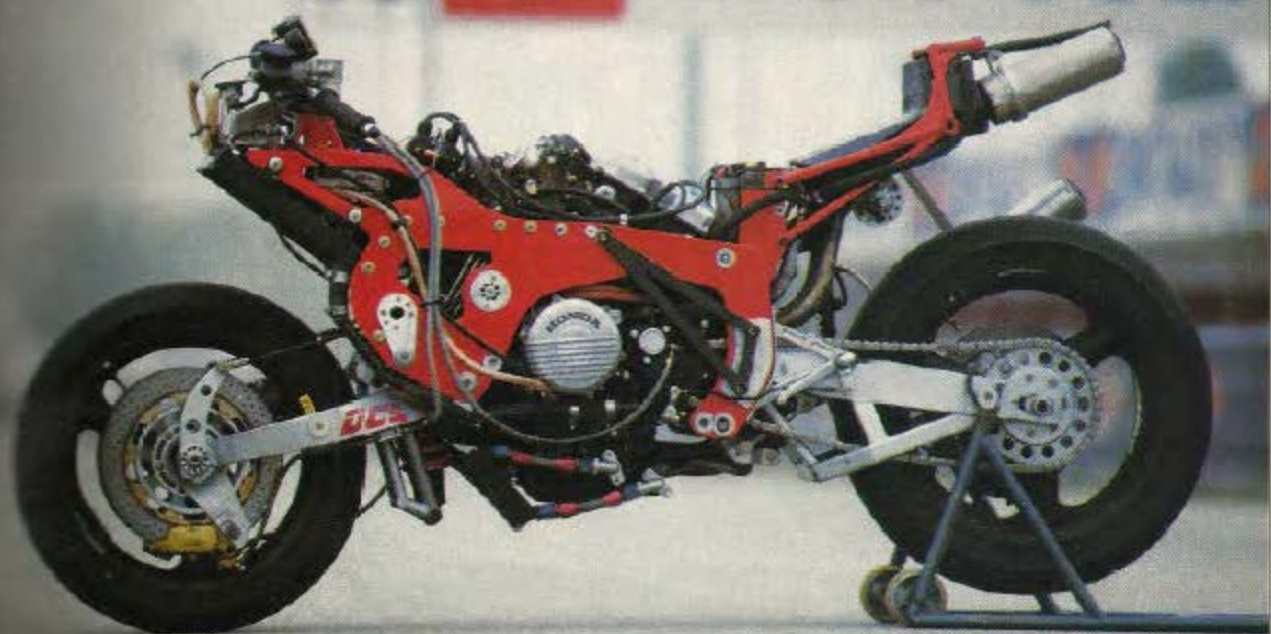
La Yamaha vencedora de Eddie Lawson. Una V-4 con sistema Power Valve y un chasis ciertamente copiado de los diseños de Antonio Cobas, con un grueso basculante de aluminio y que acciona el monoamortiguador situado verticalmente.
