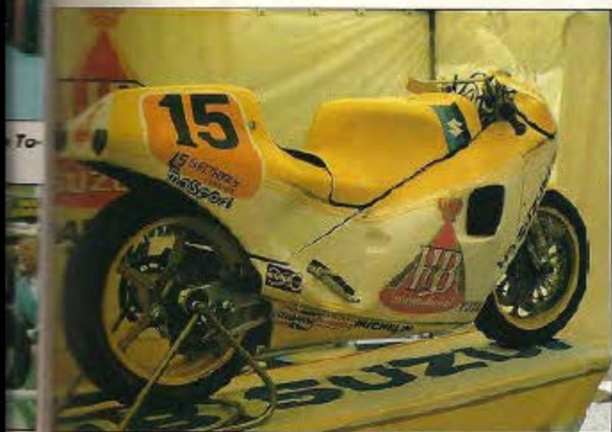
La Suzuki monocasca en «U» de Roberto Gallina con materiales especiales y que todavía no ha podido probar en carrera. Su nombre de código es TGA-1.
