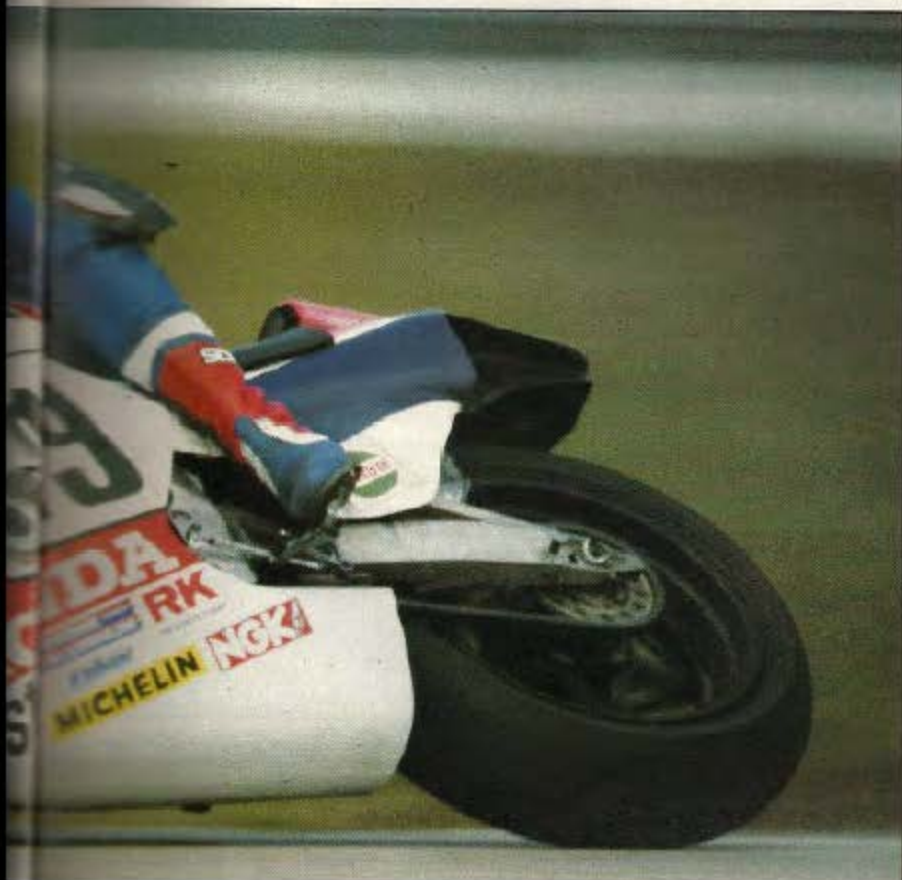
La Yamaha vencedora de Eddie Lawson. Una V-4 con sistema Power Valve y un chasis ciertamente copiado de los diseños de Antonio Cobas, con un grueso basculante de aluminio y que acciona el monoamortiguador situado verticalmente.
