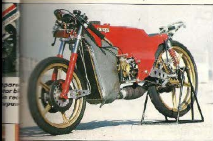
La Derbi de G.P. de Tormo y Aspar, una auténtica monocasca, refrigeración líquida y amortiguación convencional de barras.
