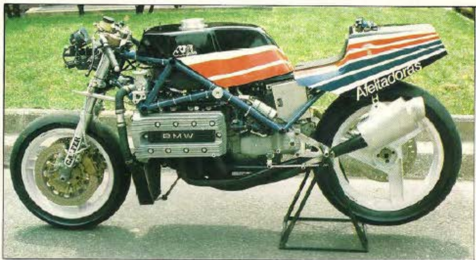
El proyecto más ambicioso y revolucionario de toda Europa construido en un tiempo record por J.J. Cobas con la ayuda de BMW y Braun. El motor es un K-100 con más de 110 CV. gracias a la intervención de Eduardo Giro, el «tecnic». Con Cardús en la Fórmula-1 Prototipos de las MOTOCICLISMO-SERIES, la BMW se alzó con la victoria.
