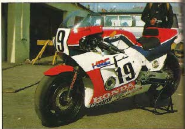
La Honda V-4 de Spencer, chasis semi-monocasco, depósito de gasolina bajo el motor, 140 CV. y empleo masivo de la braide carbono, uno de los motivos por lo que se retiró la moto en Sudáfrica al romperse la rueda posterior.
