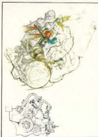
El motor GSX 750 R va refrigerado por aceite. El chasis es de aluminio de sección rectangular. La versión «racing» desarrolla 120 CV.
