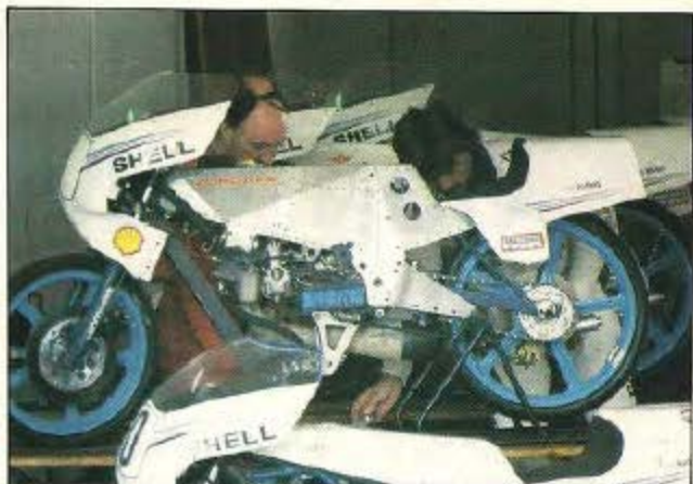
El «coco» para las Derbi, la Zündapp de Dorflinger que se alzaría con el título, en 80 c.c. En la foto, la versión con chasis monocasca ramachado.
