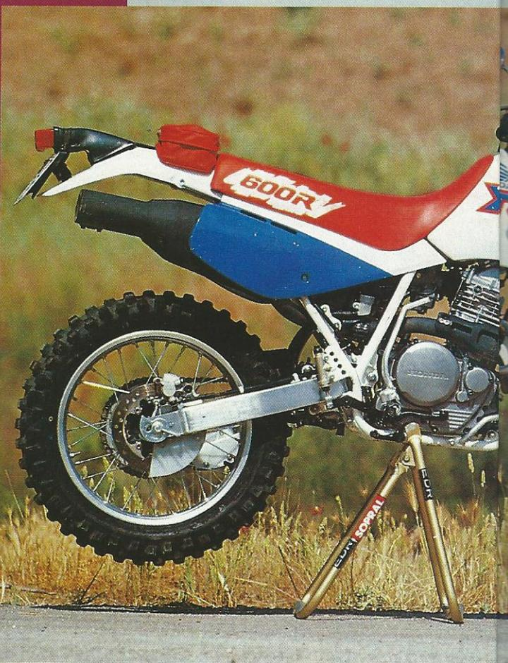
**YAMAHA:** JUNTO AL VELOCÍMETRO VA INSTALADA LA LLAVE DE CONTACTO. TRAS LA PLACA PORTANÚMEROS IZQUIERDA SE ESCONDE EL DEPÓSITO DE ACEITE, LA BOTELLA DE GAS DEL AMORTIGUADOR Y LA BATERÍA (DE SÓLO 6 V.) PARA LOS INTERMITENTES. AMORTIGUACIONES «CHAPEAU»; FRENS, EL PUNTO FLOJO.
