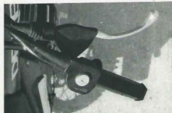
Uno de los detalles de la puesta de la moto es el puño de salida lateral que, junto con las empuñaduras exagonales y la manetas tipo Magura, forman un conjunto perfecto.
