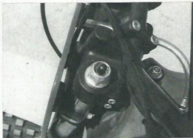
Las válvulas de llenado de las horquillas tienen un reborde que impide la utilización de algunos tipos de bombas.
