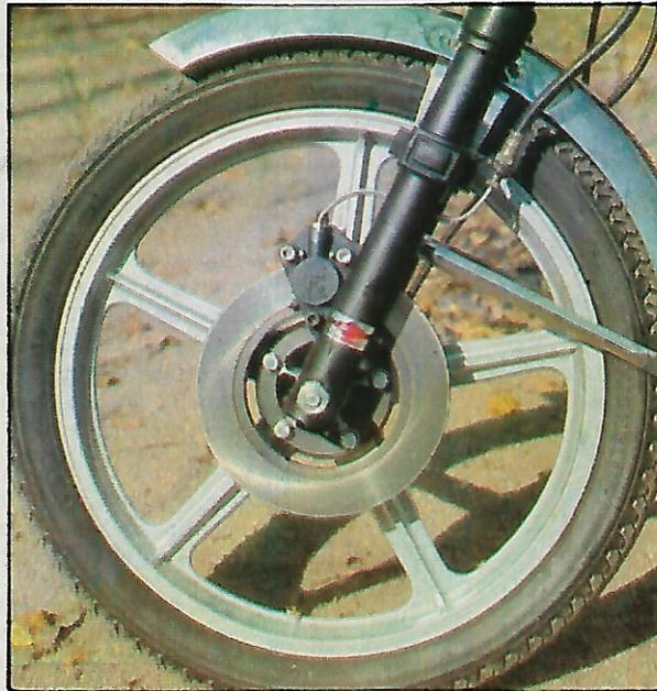
Tanto en la rueda delantera como en la trasera se monta un disco de freno Recmo de 220 mm.
