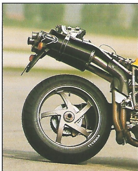
Las llantas son Marchesini, y pesan 500 gr menos que las anteriores Brembo.
