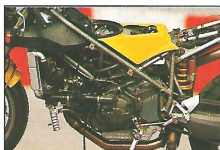
El propulsor recibe, al margen de la inyección, nuevas válvulas de admisión y escape, juntas de culata metálicas, bielas de aluminio y nuevos pistones, bombas de agua y aceite, árboles de levas...
