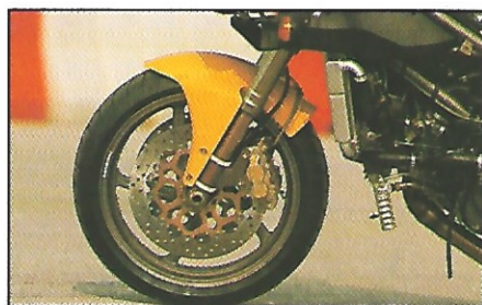
Horquilla Showa con barras de 43 mm, con tratamiento antirreflexión o discos Brembo de 320 mm.
