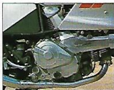
El motor en V a 90° de la Pantah volvió a dar ilusión a los hombres y fans de Ducati al comienzo de los 80.
