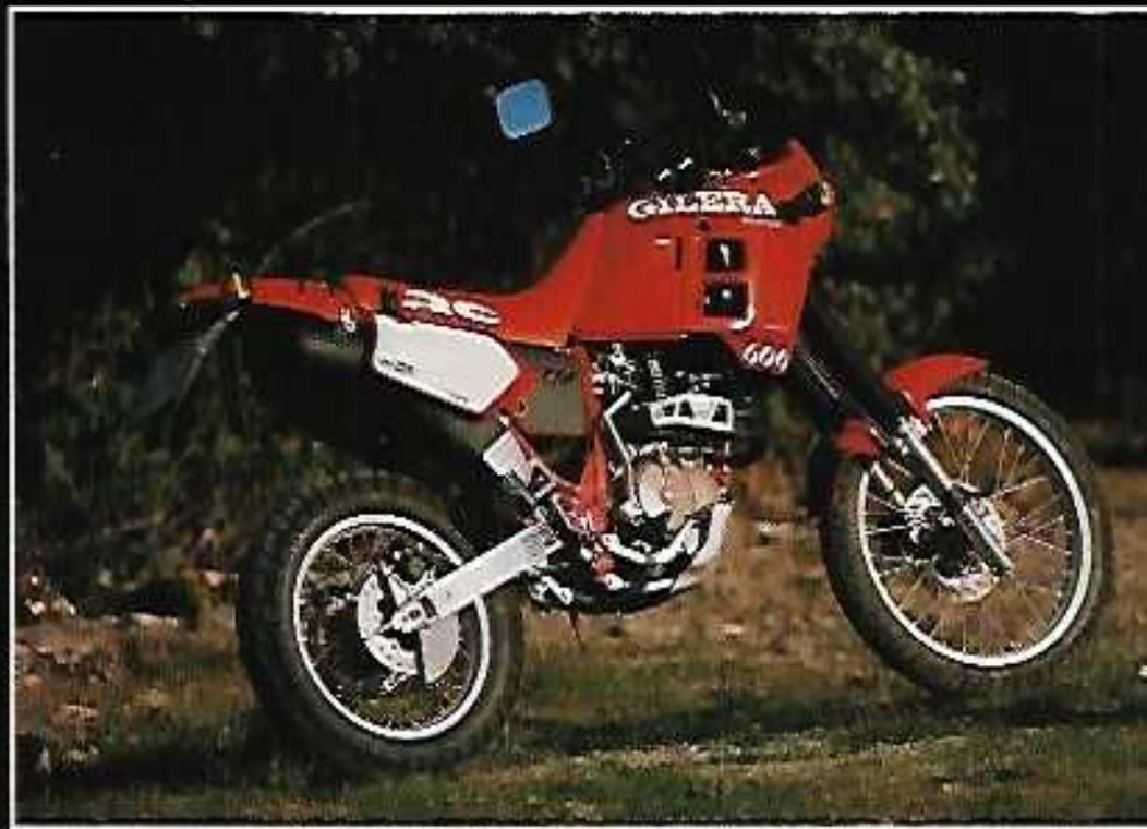
imagen de carreras de esta Gilera RC 600. Para protegerlo de los golpes se cuenta con una plancha protectora realizada en aluminio que cumple bien su función. El sistema de escape de doble salida termina en un silenciador acabado en color negro, mientras que por la izquierda, tras la tapa lateral, se esconden la caja de herramientas, bien dotada, y el depósito de gas separado del amortiguador trasero.
