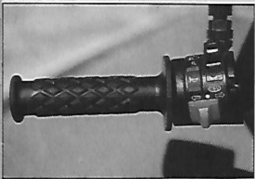
Conmutador izquierdo donde todo está en su sitio excepto el mando de cortas/largas/ráfagas. Lleva además un chivato muy práctico.
