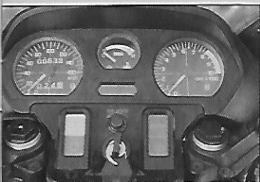
Completo y funcional cuadro de instrumentación. En el centro, el medidor de temperatura que oscila demasiado. El resto, perfecto y envidiable.
