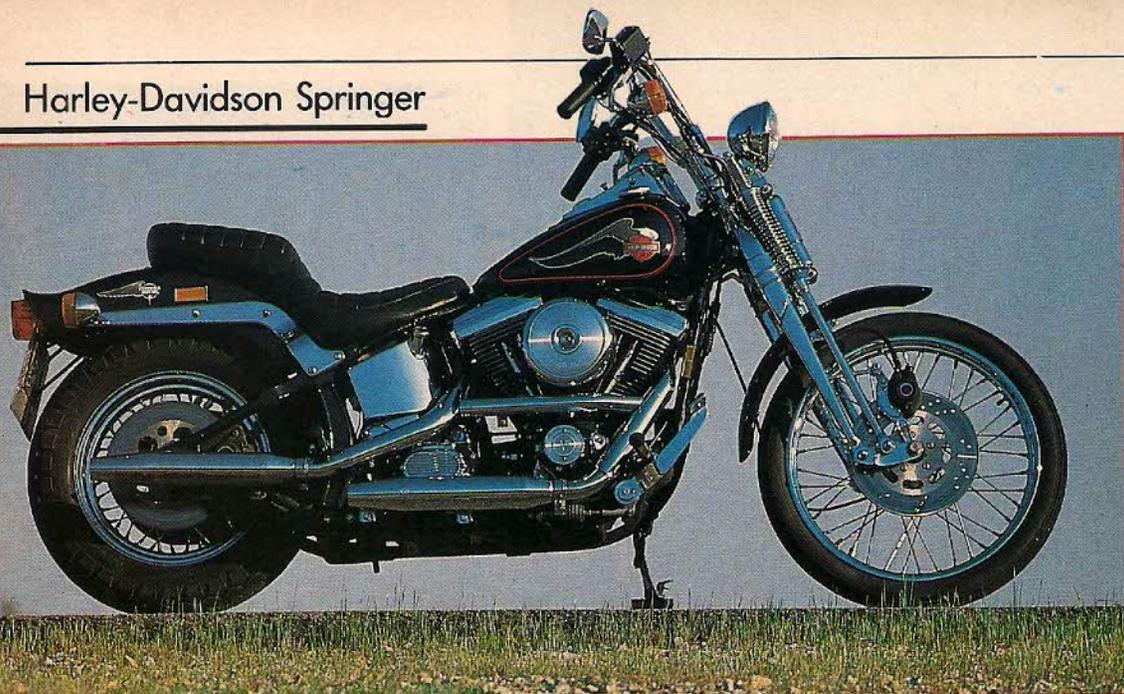
Los dos amortiguadores traseros Showa trabajan en extensión y están escondidos debajo del motor, dando la sensación que la moto está desprovista de suspensión trasera. La correa dentada no requiere casi mantenimiento y dura más que una cadena convencional. El enorme velocímetro y los testigos se hallan encima del depósito. En primer plano se puede apreciar el clásico interruptor metálico donde va la llave.
