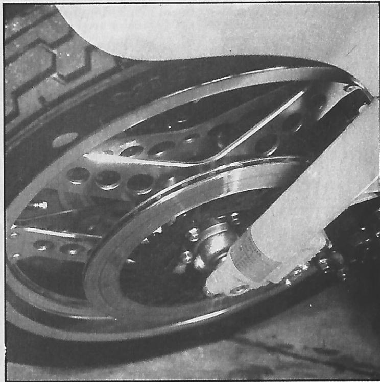
Una auténtica delicadeza técnica: frenos autoventilados como los que montan las actuales CBX seis cilindros con suspensión Pro-Link.
