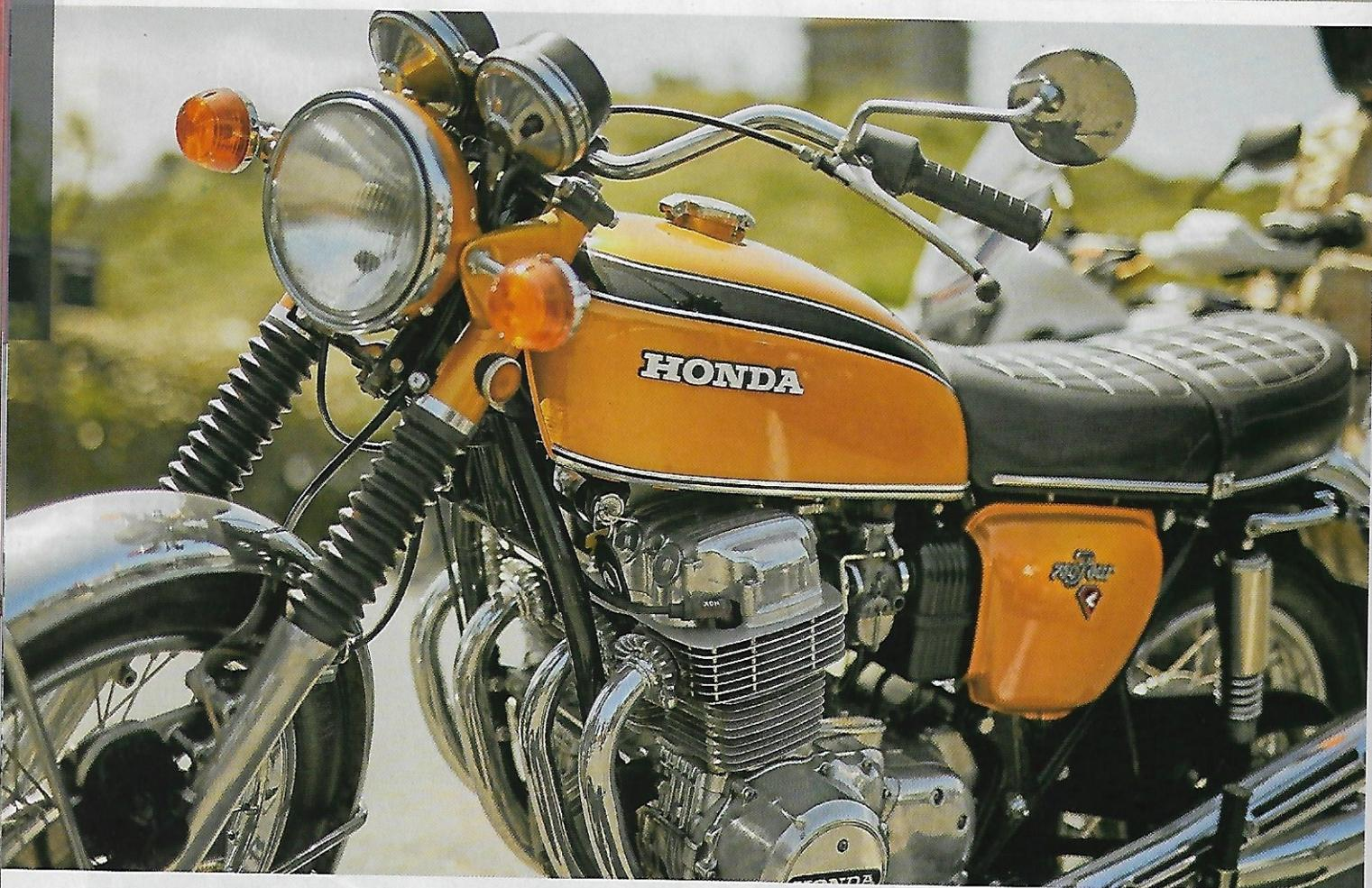
El tetracilindrico en línea fue toda una revolución y se alimentaba por cuatro carburadores Keihin.
