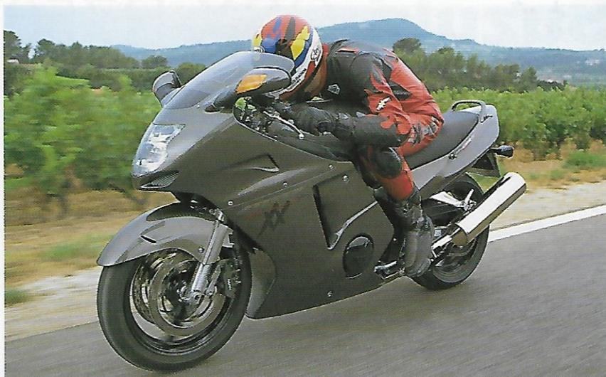
*Arriba:* Una velocidad de 290 km/h convirtió a la Super Blackbird en la moto de serie más rápida, pero su respuesta a medio régimen se mantuvo floja hasta que Honda sustituyó los carburadores por el sistema de inyección de combustible.
