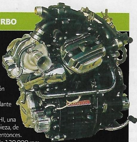
A pesar de ser un motor bicilíndrico de 500 cc, el de la CX500 Turbo no es precisamente pequeño. Fue diseñado a mitad de los años 70 y, en ese momento, se le dotó de todos los aditamentos necesarios para convertirlo en el más avanzado de su época, con inyección electrónica y turbo. En la foto, si te fijas, se aprecia bien la estructura, con el turbo por delante y encima del embrague.
