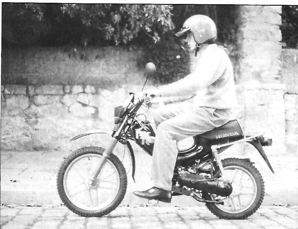
En el puño de la izquierda, mandos de aire, intermitentes y bocina. Velocímetro y llave de contacto y luces, de una sola posición, en el centro. Buena posición de conducción, con un asiento de generosas dimensiones.
