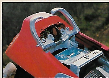
Detalle de las agarraderas retráctiles para el posible pasajero de la deportiva y turística Honda.
