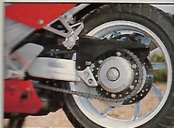
Detalle del formidable basculante monobrazo Pro Arm, con la transmisión y freno integrados.
