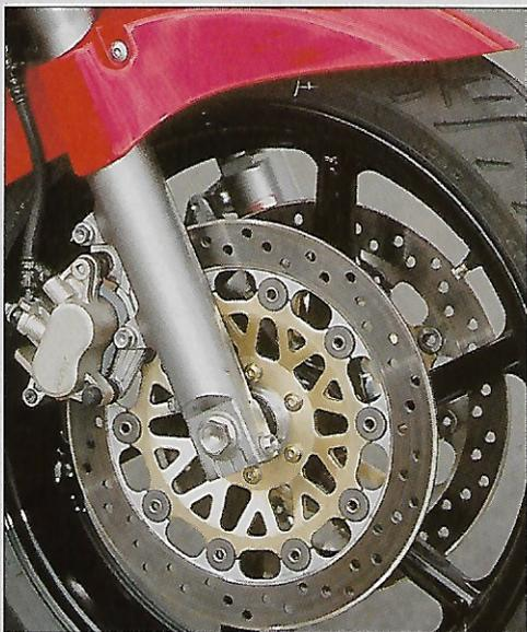
Los frenos se anclan de manera "simil-flotante" para rebajar el peso del conjunto de la rueda.
