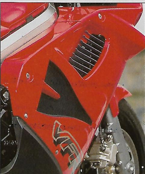
Las nuevas entradas y salidas de aire mejoran los flujos internos del aire alrededor del motor y bajo el asiento.
