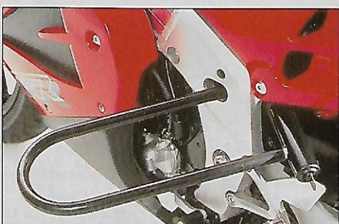
El orificio del chasis en el lateral de la zona del eje del basculante permite atar la moto a un lugar fijo.
