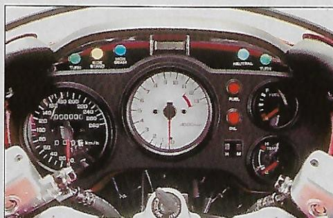
El cuadro de instrumentos es nuevo: lleva reloj horario y testigo de alerta de combustible a los 4.4 litros.
