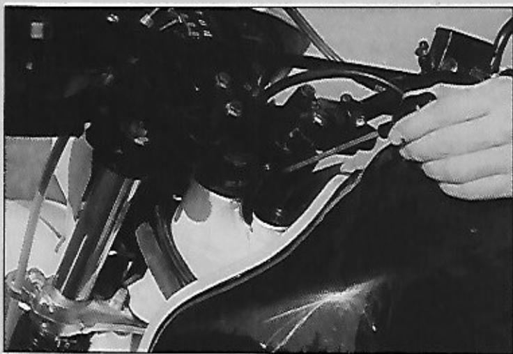
Entre el depósito y la pipa de dirección, el tapón de aceite, que aprovecha el chasis como depósito.
