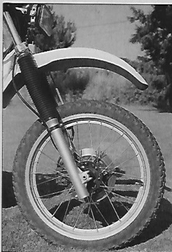
La rueda delantera, también sin cámara, monta freno de disco con pinza de doble pistón. Horquilla oleoneumática con barras de 43.
