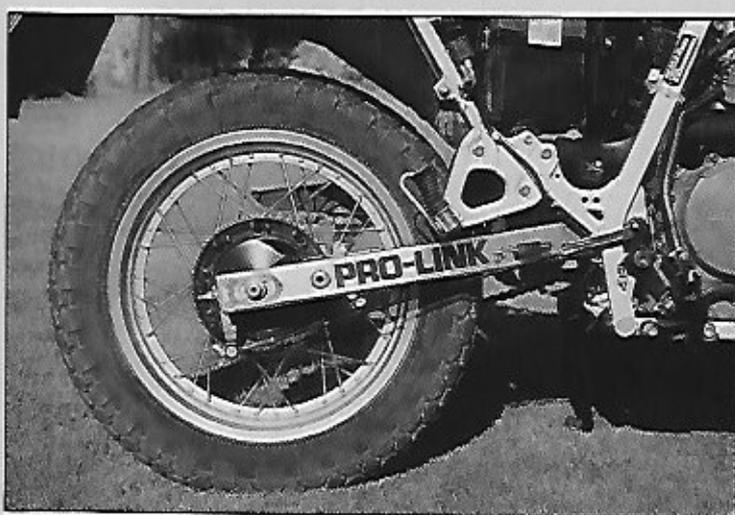
La rueda trasera, sin cámara y con freno de tambor, lleva neumático mixto, bueno para asfalto, pero limitado para la carretera.
