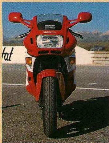
*Una nueva decoración distingue a la CBR 600 «tercera edición», pero la principal diferencia se encuentra oculta, en la inyección de ocho CV. extra recibida por su motor. La cúpula del carenado sigue ofreciendo una protección insuficiente. Arriba derecha, dos buenos argumentos de la CBR, completo equipamiento y un aceptable lugar reservado para el pasajero.*
