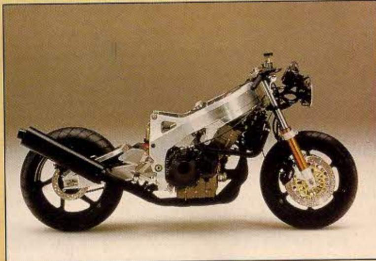
Los 185 kilos del conjunto en toda su esplendor sin carrocería: un bastidor doble viga de aluminio y la optimización máxima de diseño es la guía que permitió conseguirlo...
