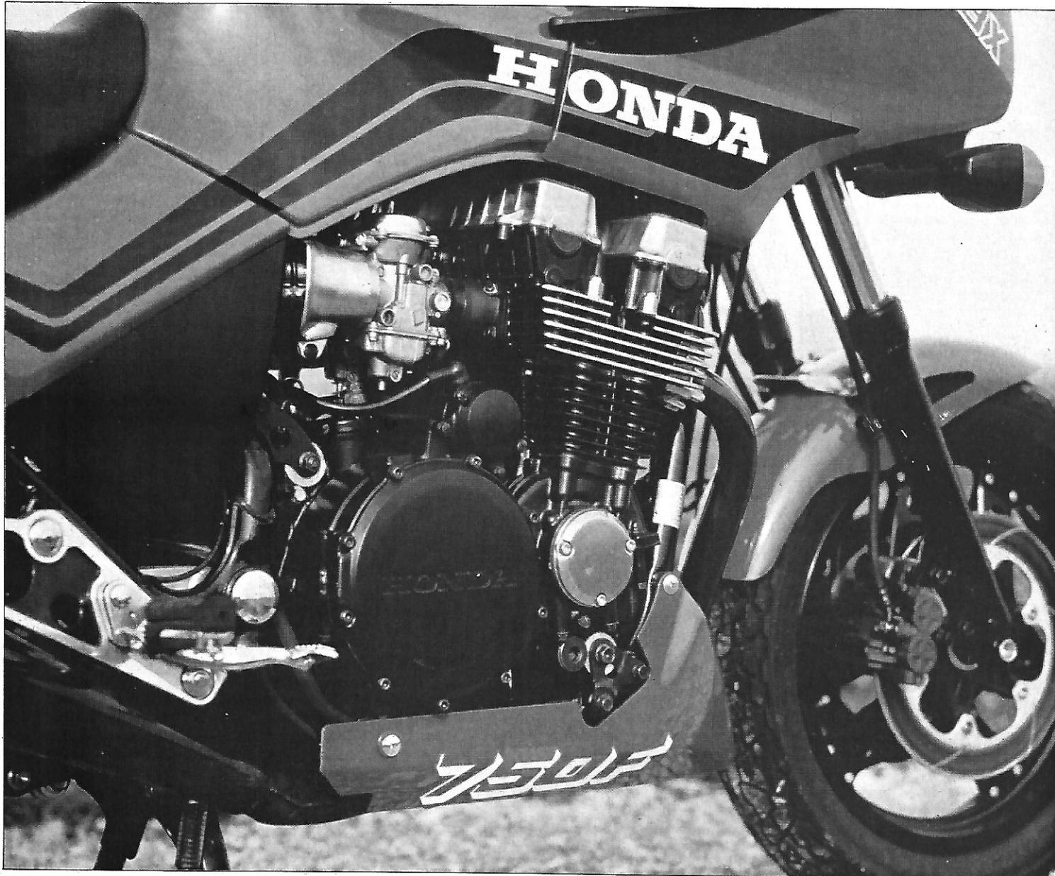
*El motor tiene menos capacidad de aceite y, para paliar este defecto, los tubos inferiores del chasis cumplen la misión de recipiente.*
