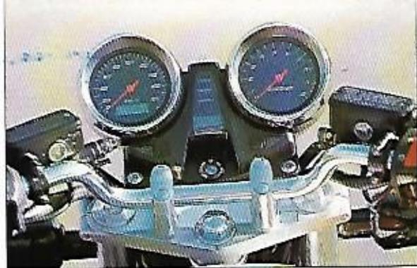
Instrumental clásico pero con dos detalles (kilométricos y nivel depósito) en información digital.
