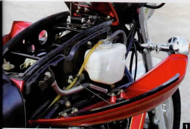
1. El depósito de gasolina no es tal y en su hueco se encuentra el sistema eléctrico, una guantera y la boca de llenado para la gasolina.
