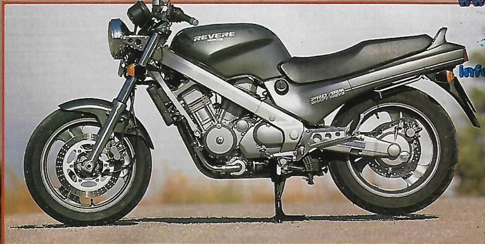
la personalidad de la NTV. Tan sólo el depósito, apoyado directamente sobre las vigas del chasis, oculta el antiestético carburador y filtro de aire.
