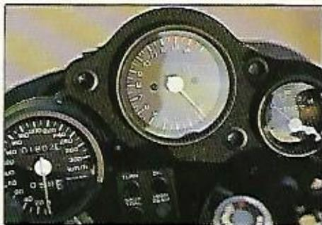
*El velocímetro, demasiado recargado de números, tiene placa soporte independiente del termómetro de agua y del cuentavueltas para poder desmontarlo con facilidad pensando en el circuito. Depósito de aluminio y carrocería ultraligera en tres piezas. El escape es de acero inoxidable. Horquilla y pinzas de freno han sido diseñadas pensando en cambios rápidos de ruedas o pastillas.*
