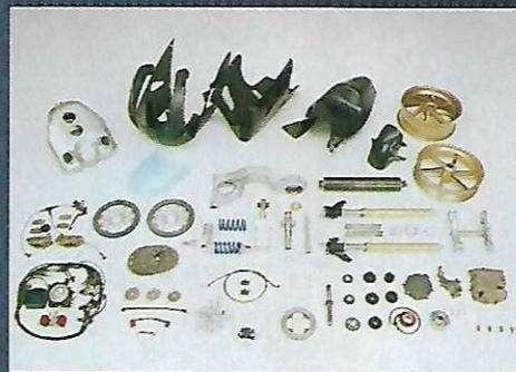
lador de presión de gasolina, depósitos de rebosamiento. Unidad PGM-FI y panel de control, unidad de encendido racing, mazo de cableado, kit de modificación del depósito de combustible, bridas de anclaje de las pinzas de freno delanteras, desarrollos y cadena.
