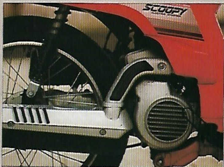
El mismo escape hace de brazo derecho de basculante. Este se muestra muy silencioso y poco «fumador». El cilindro se sitúa en posición vertical y va refrigerado por circulación forzada de aire.
