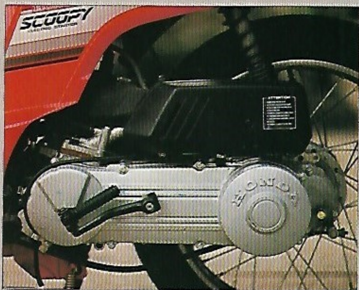
La transmisión es automática por variador, el mismo sistema que utilizan todos los ciclomotores punteros.
