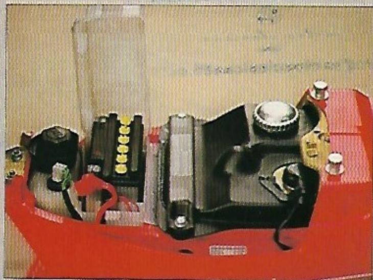
El Honda Scoopy 80 esconde bajo el asiento los depósitos de combustible y aceite y la batería de 12 V. 4A h., corazón eléctrico de este pseudo-scooter.
