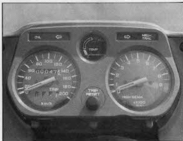
El tablero de instrumentos es muy completo, y por fin una trail lleva testigo de presión de aceite. Destacar su clara lectura, su precisión, y el testigo de la luz larga colocada en la parte inferior del tacómetro.
