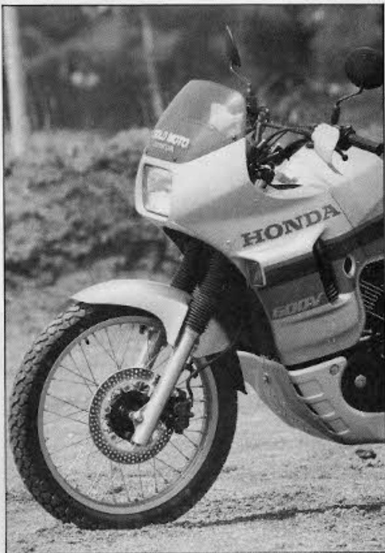
Carenado integral secundado con un gran protector del motor y chasis, guardabarros bajo, robusta horquilla de 41 m/m. de sección de barras, y un potente disco de 276 m/m. con pinzas de doble pistón, casi una superbike de carretera.
