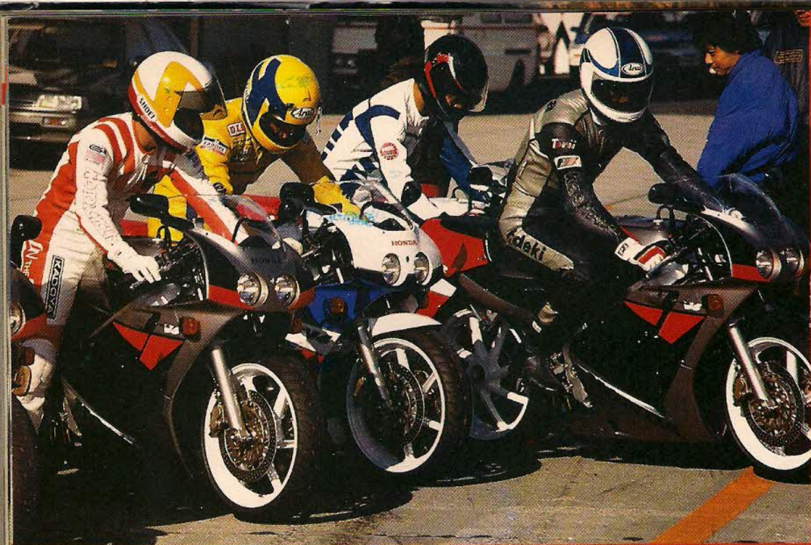
Presentación y primera prueba (multitudinaria, como siempre) en Suzuka. El chasis de la NC 30 es de aluminio y mantiene el basculante monobrazo Pro-Arm. Los carburadores tienen una entrada auxiliar de aire a la altura de las membranas para evitar la «sobredosis» de gasolina en las retenciones.
