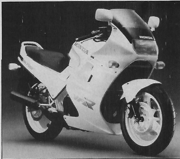
*Guardabarros aerodinámico, rueda de 16" delante y la parte superior del carenado que recuerda como dos gotas de agua al de la Honda CX 500 Turbo.*
