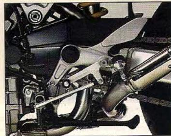
Las estriberas se sujetan a los extremos del basculante y se fijan mediante una tuerca a la pieza inferior del cárter, consiguiendo ahorrar unos gramos de peso al conjunto, que totaliza 192 kilos en vacío.
