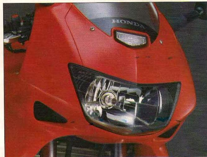
El gran faro emplea tecnología de curvatura múltiple (Multiconvex), para conseguir un claro y amplio haz de luz para mayor seguridad del motorista. La luz de posición está por encima de éste, en el carenado.
