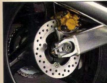
El disco posterior es de 220 x 5,0 mm. con pinza de simple pistón. El basculante es un robusto tubo de aluminio de 40 x 90 mm., con portaeje de fundición mecanizado.
