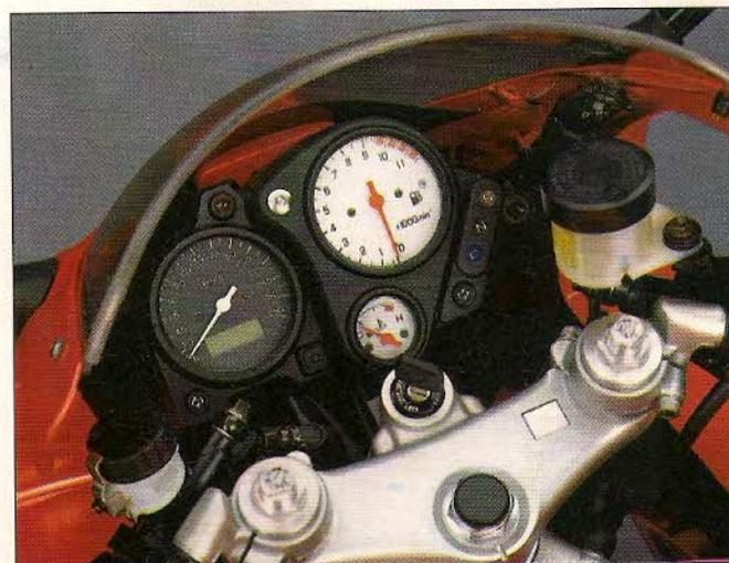
El tablero de instrumentos es electrónico, con la esfera del tacómetro en blanco y un parcializador-totalizador kilométrico digital. La reserva de gasolina se hace a través de un led, cuando quedan 2,5 litros en el depósito.
