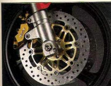
Los discos delanteros son de 296 mm. y 4,5 de grosor, con pinzas de cuatro pistones, algo extraño en Honda, pues sólo las montan la CBR 900 RR y RC-45, además de la ya legendaria NR 750.
