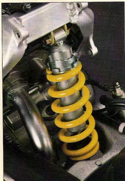
El monoamortiguador posterior es ajustable en sus tres vías y actúa sobre unas bielas Delta-Link sujetas a la parte inferior del cárter motor a través de una pieza de aluminio. El basculante se ancla directamente a los cárteres del motor.
