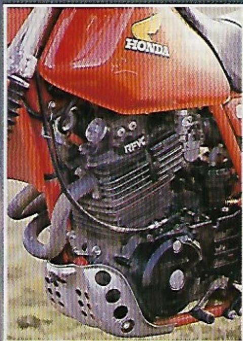
Una plancha de duraluminio protege los bajos de la XL. Dentro de lo que cabe es un motor estrecho, siendo difícil golpearlo, además, tanto la palanca de cambio como la del freno son de punta articulada.
