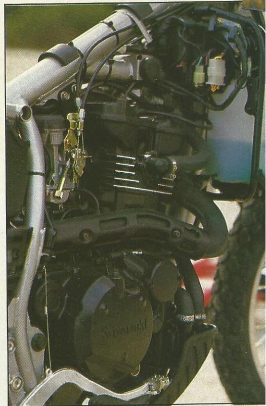
Impresionante motor de 651 c.c. y 48 CV.; es el «mono» más grande, con doble árbol de levas, culata de cuatro válvulas y refrigeración líquida.
