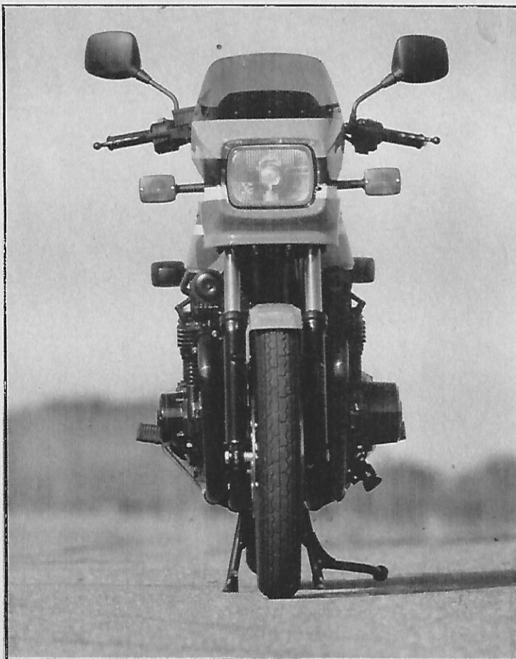
La anchura del motor perjudica la penetración aerodinámica y la pata de cabra limita inclinaciones. La cúpula es eficaz, aun a alta velocidad.
