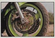
Frenos delanteros de 310, flotantes, con pinza de 4 pistones. Rueda de aleación, neumáticos Dunlop Sportmax. Todo de gran efectividad.
